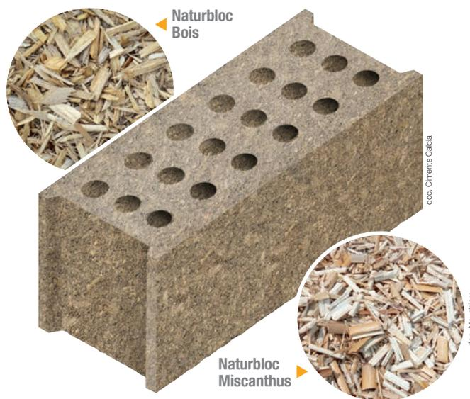
*CO<sub>2</sub> stocké, bloc structurel B30 (R+2), pose maçonnée, résistance thermique  $\geq 0,7 \text{ m}^2 \cdot \text{K/W}$ , isolement acoustique  $\geq 50 \text{ dB}$ , qualité de l'air intérieure A+, tenue au feu 4 heures, 100 % recyclable : Naturbloc, Miscanthus et Bois, multiplie les performances pour assurer la qualité du bâti !*
